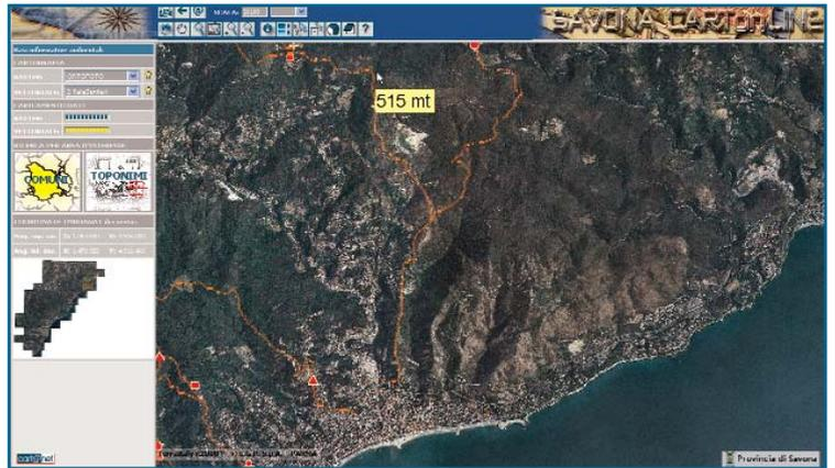
E' inoltre possibile realizzare interattivamente un grafico altimetrico di ogni elemento (ad es. una strada) presente sulla mappa. Il grafico è ottenuto dal valore di quota del pixel del DEM nei punti di coordinate pari a quelle corrispondenti ai vertici della polilinea (la strada) con la distanza in metri tra i vertici stessi.
