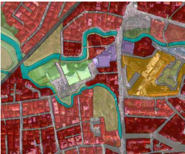
Figura 2 - Copertura del suolo ottenuta dal Progetto GSE Land, sovrapposta all'immagine satellitare rilevata con GeoEye1
