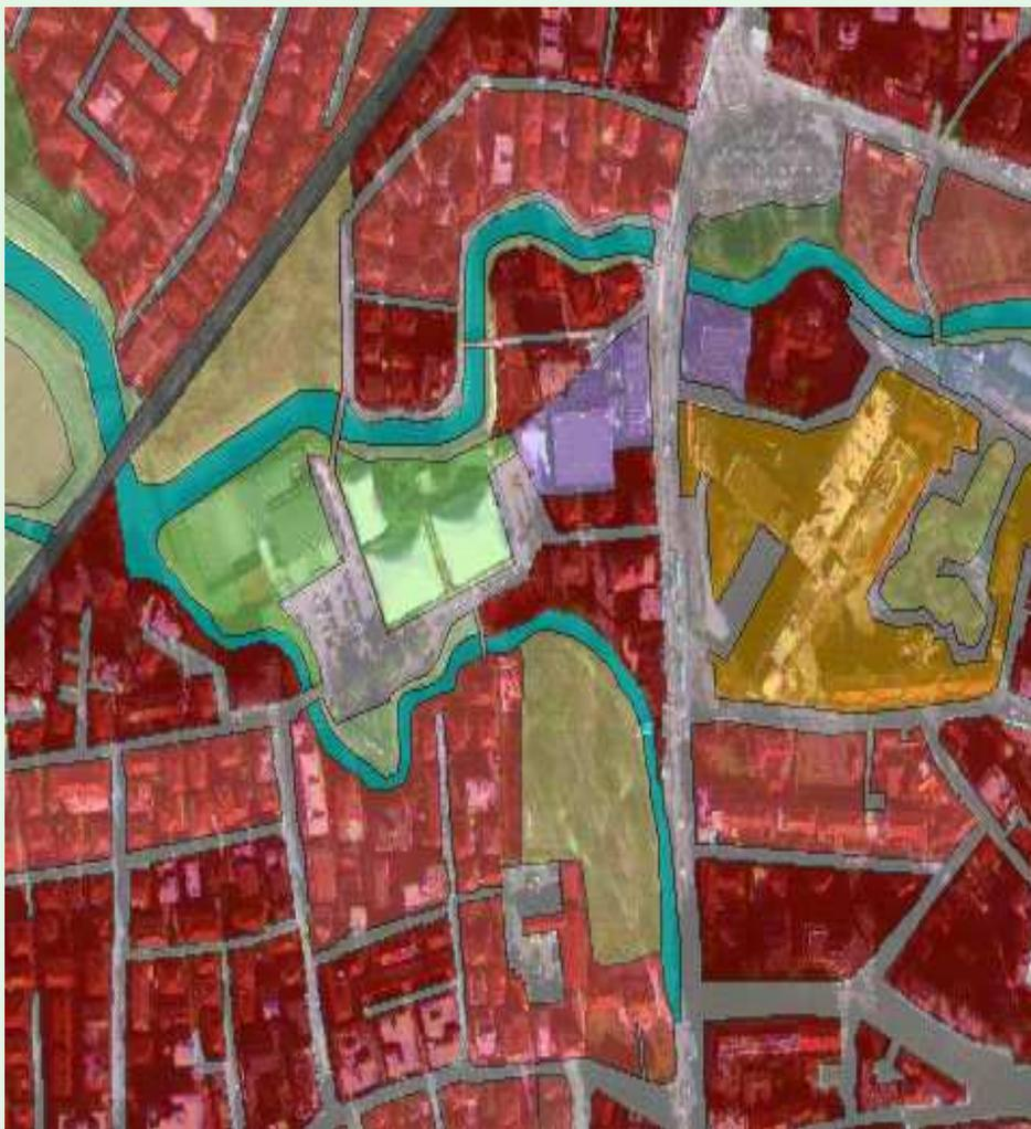
Immagini satellitari di nuova generazione caratterizzate da una risoluzione geometrica dell'ordine del metro. L'utilizzo della tecnologia del sensore **GeoEye1** consente di generare una **carta di copertura del suolo** a più elevato dettaglio geometrico e tematico, fino alla delineazione del singolo edificio
