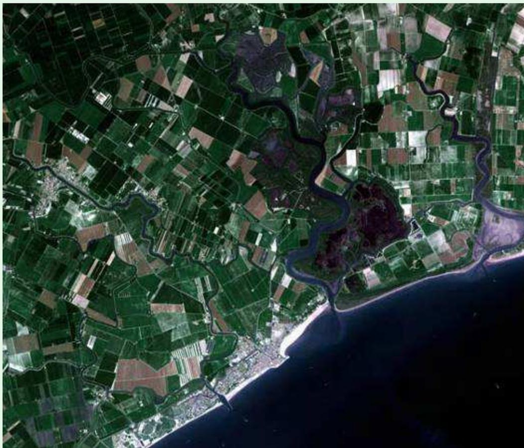
L'immagine satellitare **Spot V** attraverso un particolare processamento denominato *Supermode* può ottenere un miglioramento della risoluzione geometrica, in modalità pancromatica, da 5 m a 2,5 m
