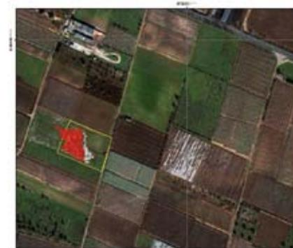
Subset del sito di prova attestante l'output del processamento automatico (in rosso) e la perimetrazione finale di una discarica di rifiuti illegale (in giallo). L'immagine WorldView2 permette di identificare e riconoscere le tracce del trasporto illegale di materiale al sito. (Immagine: Planetek Italia s.r.l.)
